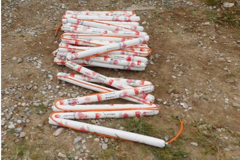
**Emuline** es una emulsión sensible al detonador en cartuchos continuos diseñada para aplicaciones de voladuras controladas donde se requiere desacoplamiento de la carga.
