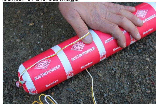
Obr. 4: Udělejte z drátu smyčku, min. v 1/3 délky náložky od rozbušky
