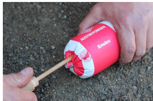
Obr. 2: Udělejte axiální otvor adjustačním kolíkem
