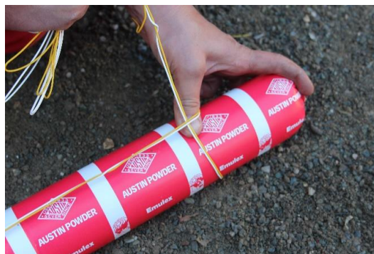
Obr. 6: Udělejte druhou smyčku Pic. 6: Hitch wires around a second time
