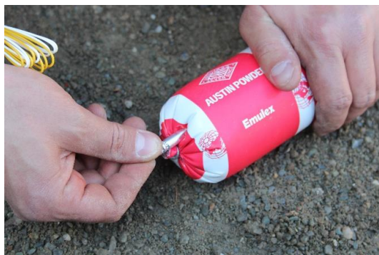
Obr. 3: Zasuňte rozbušku, dokud nebude zcela zasunuta uprostřed náložky
