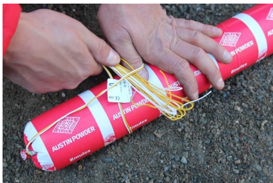
Obr. 5: Protáhněte drát smyčkou Pic. 5: Pull the wire through the loop
