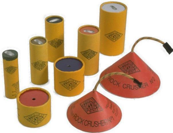
Les **relais d'amorçage coulés DC** d'Austin Powder sont des explosifs moléculaires polyvalents de haute densité conçus pour produire des pressions de détonation élevées pour un amorçage optimal des agents de sautage. Les relais d'amorçage coulés DC sont sensibles à un détonateur à charge de base PETN de 450 mg, ou à un cordeau détonant d'au moins 15 grains par pied.
