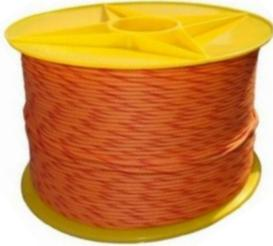
El CORDÓN DETONANTE AB es un accesorio de voladura, que posee características como: alta velocidad de detonación, facilidad de manipuleo y seguridad. Está formado por un núcleo de pentrita (PETN), el cual está recubierto con fibras sintéticas y forrado con un material plástico y adicionalmente se utiliza hilos y resinas parafinadas para dotar al producto de una mayor resistencia a la abrasión y tracción.
