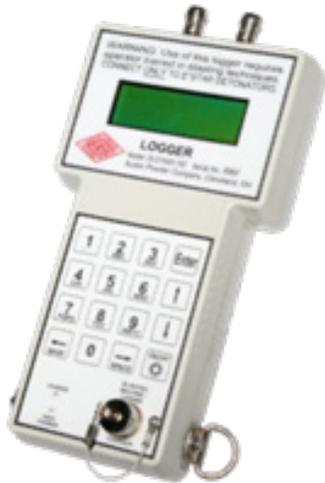
El Logger **DLG1600-100** se usa para programar detonadores E★STAR, verificar y medir la corriente de fuga en las ramas. También se utiliza para transferir datos entre Loggers, a la caja explosora, desde y hacia una PC y permite la revisión de detonadores programados. Para una conexión fácil y rápida al detonador es posible usar el adaptador modelo 1 o el adaptador modelo 2.
