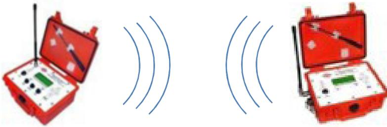
El sistema **WIRELESS REMOTE FIRING DEVICE (WRFD)** permite al usuario realizar la voladura desde una distancia segura sin usar una línea de disparo larga a la caja explosora. El WRFD consta de una unidad de control remoto (WRFD-R- 1) y una unidad de puente remoto (WRDF-B-1). El control remoto y las unidades de puente remoto se comunican por señales de radio. Estas unidades están emparejadas por un número de serie específico.
