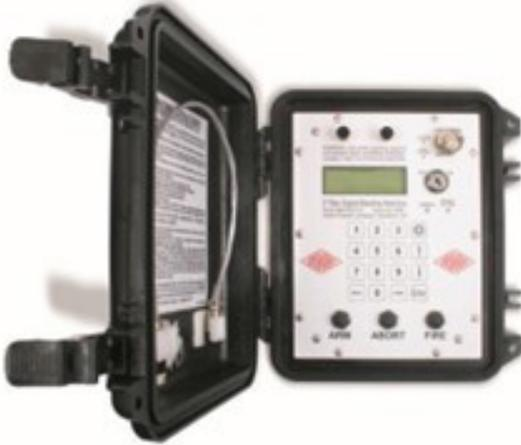
**DBM1600-2-K** La caja explosora es un dispositivo multipropósito diseñado para trabajar con detonadores E★STAR. Las funciones principales del DBM1600-2-K son verificar, cargar y disparar todos los detonadores en todas las ramas. Es posible disparar hasta 1.600 detonadores E★STAR por voladura. Si se conecta con una segunda caja explosora DBM1600-2-K a través del módulo DIM1 en modo maestro-esclavo, es posible disparar hasta 3.200 detonadores E★STAR por voladura.
