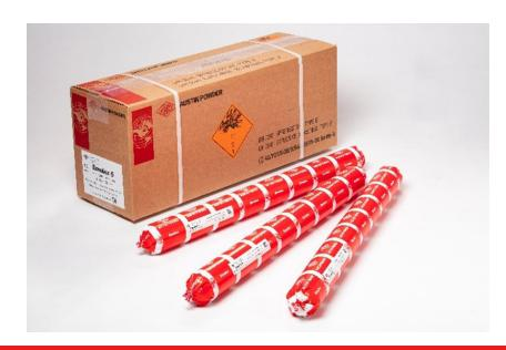
Emulex 5 ist ein kapselempfindlicher Emulsionssprengstoff mit einer exzellenten Kombination aus Detonationsgeschwindigkeit, Gasentwicklung und spezifischer Energie. Zusätzlich zu Aluminium enthält es feste AN Prills. Dadurch ist das Produkt fester und kann besser in Wasser führenden Bohrlöchern eingesetzt werden.
