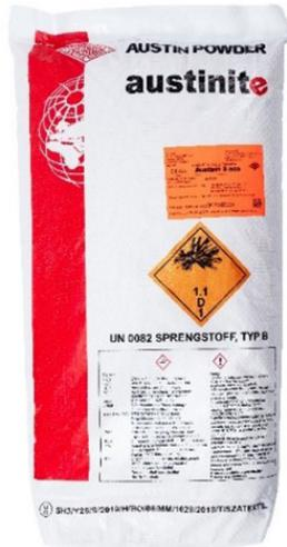
**Austinite 3 eco** besteht aus Ammoniumnitrat, Aluminium und Mineralöl. Mit dem Aluminiumzusatz besitzt diese Variante von ANFO eine besonders schiebende Wirkung. Austinite 3 eco ist nicht wasserfest und kann daher nur unter trockenen Bedingungen oder zusammen mit einem Ladeschlauch verwendet werden. Da ANFO nicht sprengkapselempfindlich ist, empfehlen wir patronierte Emulsionssprengstoffe (z.B. Emulex 1 oder APB) als Verstärkerladung zu benutzen.
