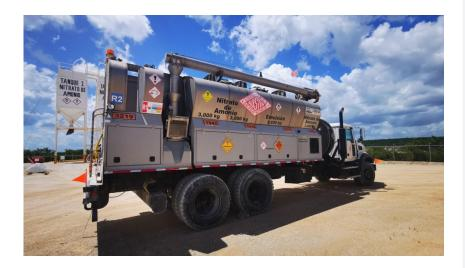
**Hydromite 70** es un agente de voladura en emulsión, se produce en sitio a partir de una mezcla de 70% de Hydrox S con 30% de nitrato de amonio de baja densidad y combustible sensibilizado por gasificación química.
