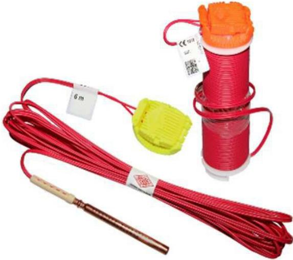
Los **Detonadores electrónicos E★STAR** se caracterizan por una máxima seguridad, precisión de tiempo y variabilidad de iniciación para la mayoría de las aplicaciones de voladura. Usando el equipo E★STAR Tester es posible comprobar los detonadores en cualquier momento y con el equipo E★STAR Logger es posible programarlos para cualquier retardo dentro del rango de 1 a 20.000 ms. Con el dispositivo E★STAR Blaster es posible disparar hasta 1.600 detonadores por voladura.
