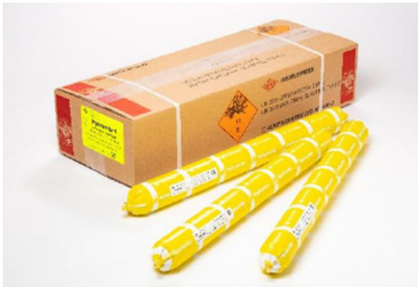
**Hydromite 1** es un agente de voladura basado en una emulsión mezclada con nitrato de amonio; proporcionando una excelente combinación de velocidad de detonación y volumen de gas. Ampliamente utilizado en minería de superficie, canteras y trabajos de construcción. Excelentes resultados logrados cuando se utiliza como carga de columna o como carga base. Hydromite 1 puede iniciarse mediante un cartucho de tamaño adecuado de Emulex 1 o una carga de refuerzo (APB).
