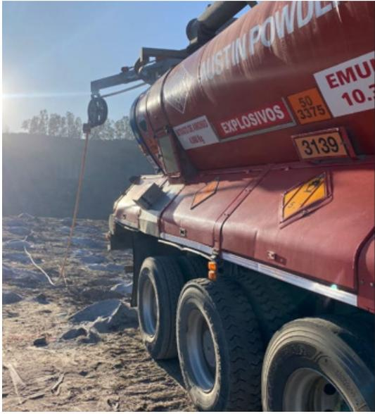
**Hydromite 70** es una emulsión a granel sensible al booster, fabricada con una mezcla del 70% de Hydrox S con un 30% de nitrato de amonio de baja densidad y aceite combustible. Esta emulsión es sensibilizada mediante gasificación química. Hydromite 70 se utiliza ampliamente en trabajos de minería a cielo abierto, canteras, cementeras y obras civiles. Hydromite 70 no es sensible al detonador y puede ser iniciada con un cartucho de Emulex 1 o un APB.
