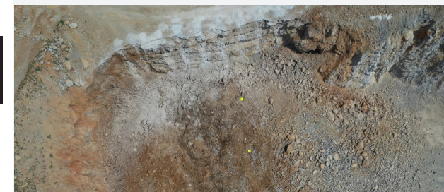
Figur 2 – Resultat av optimerad E*STAR-sprängning
